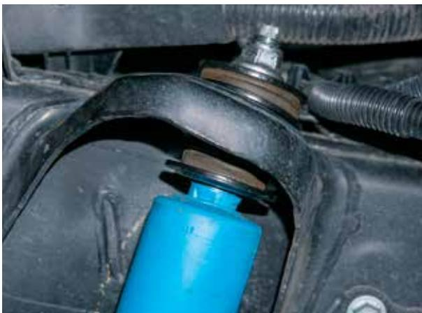
Fig. 10: Remove stem top nut.
