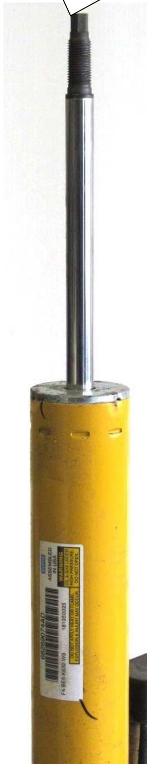
Mitgeliefertes Anschlagelement mit Staubschutzrohr auf den Dämpfer aufstecken.
