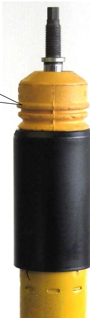
Original Stützlager aufstecken und mit der original Mutter verschrauben. Die Montagehinweise zum Einbau des Dämpfers in das Fahrzeug, sowie die Anzugsdrehmomente der Federbeinfestigung, entnehmen Sie bitte den Unterlagen des Fahrzeughändlers.
