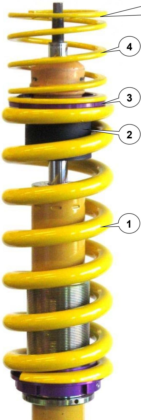
Folgende mitgelieferte Teile in der Reihenfolge auf das Federbein aufstecken: Hauptfeder 1, Federwegsbegrenzer mit Staubschutzrohr 2, Zwischenring 3 und Vorspannfeder 3.
