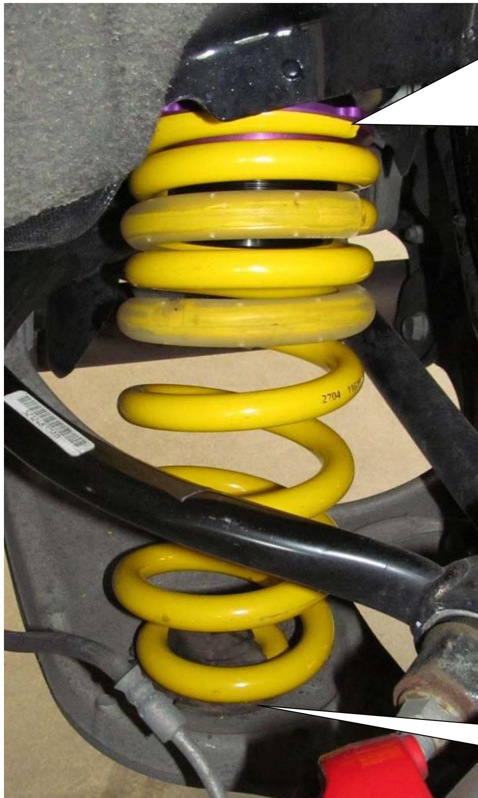
Die HA-Verstellung wird oben zwischen Feder und Karosserie montiert. Die serienmäßige Federunterlage entfällt. Zum Korrigieren (verdrehen des Gewindestange) der Fahrzeughöhe, ist die HA-Verstellung aus dem Fahrzeug zu demontieren.
