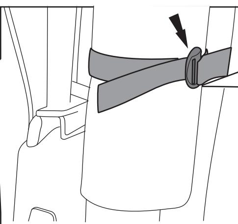
Nota: Las correas deben estar apretadas y pueden ajustarse posteriormente para montar correctamente el cobertor de caja.
