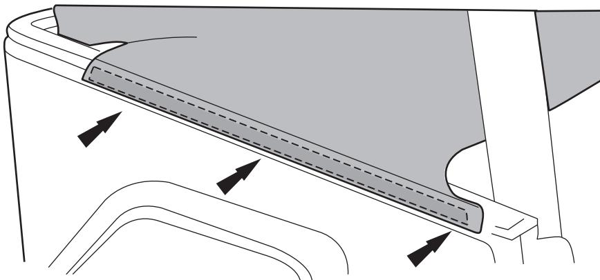
Replier la bande en plastique dans le rail de la ceinture du bac dans la zone des feux arrière.
