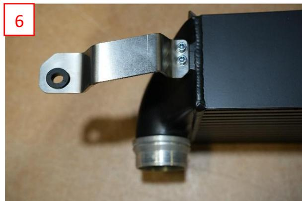
Positionieren Sie den WT-LLK an der originalen Position, achten Sie darauf das die oberen Halter über dem Rahmen liegen und verbinden ihn dann mit den originalen Silikonschläuchen.(7)
