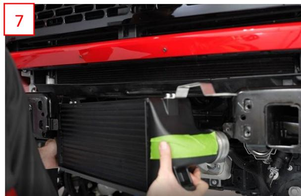
Montieren Sie die oberen Halter, an den Originalen Verschraubpunketen, der OEM Ladeluftkühlerhalterung.(8)
