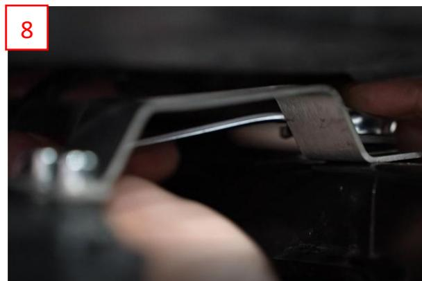
Montieren Sie wieder die untere Ladeluftkühleraufnahme auf beiden Seiten(9) und Installieren Sie die Fahrzeugkomponenten in umgekehrter Reihenfolge.
